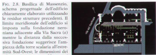
FIG. 2.8. Basilica di Massenzio, schema progettuale dell'edificio chiaramente elaborato utilizzando le residue strutture precedenti. Il limite meridionale dell'edificio si imposta sulla fondazione neroniana adiacente alla Via Sacra (a) mentre la distanza dalla successiva fondazione suggerisce l'ampiezza della torre scalaria all'estremità Sud-Ovest; le dimensioni dei piloni portanti sono calibrate sui contrafforti neroniani, a volte utilizzati come casseforme per le relative fondazioni (b); l'ampiezza e la posizione del muro di testata Ovest trae origine dalle residue murature flavie, anch'esse sfruttate come casseforme (c). Probabilmente non a caso solo il settore Nord, costruito su terreno vergine, non ha subito crolli.
