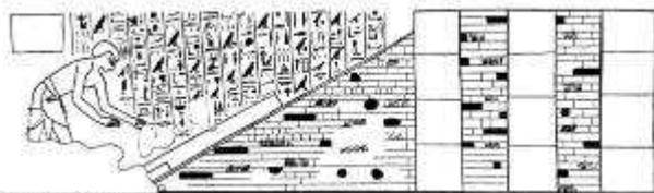
Fig. 387 - Scene dalla tomba di Rekmire a Tebe (XVIII dinastia) raffigurante una rampa in mattoni crudi utilizzata per la costruzione di un edificio (NEWBERRY 1900)
