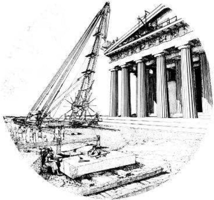
Fig. 391 - Ricostruzione di una macchina di sollevamento del cantiere del Partenone (KORRES 1995)
