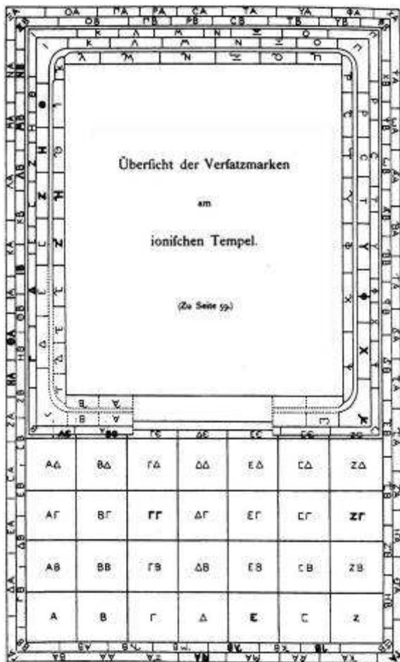
Fig. 399 - Pergamo. Tempio ionico della Terrazza del Teatro. Numerazione dei blocchi con le lettere (prima metà del II sec. a.C.) (BOHN 1896)
