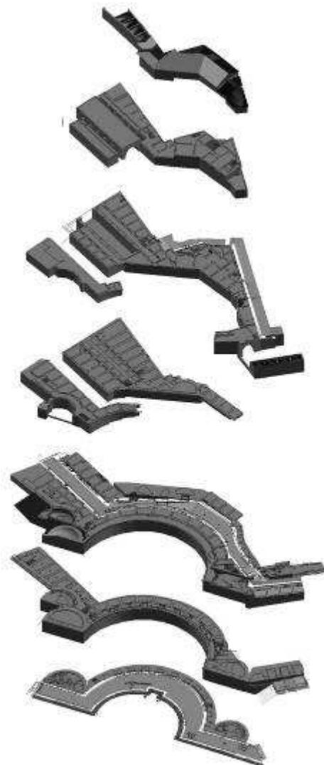
► Fig. 522 - Roma. Mercati di Traiano. Assonometrie schematiche dei sette livelli principali del complesso (ricostr. M. Bianchini, in [www.rilievoarcheologico.it](http://www.rilievoarcheologico.it))
